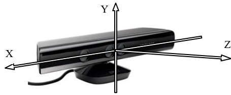
รูปที่ 1 แกน X, Y และ Z ของกล้อง Kinect [3]
